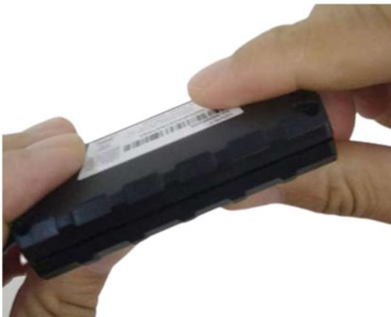
**Instalação de Cartão SIM:** Abra a carcaça e verifique se o dispositivo não está ligado (desconecte o cabo de 5 pinos e coloque a bateria interna na posição OFF). Deslize o abametalico em direção a bateria para abrir o suporte do SIM Card. Insira o cartão SIM no suporte, como mostrado abaixo, com a área de contato dourada virada para baixo. Tome cuidado para alinhar a marca de corte. Feche o suporte do SIM Card. Feche a carcaça.
