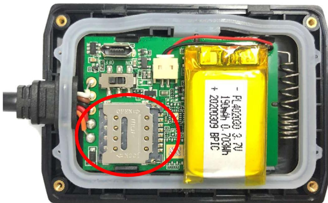
**Instalando a bateria de backup interna:** O GV57 é distribuído com uma bateria interna de backup de Lítium-ion. Antes de usar o equipamento verifique se a bateria está conectada como na figura abaixo.
