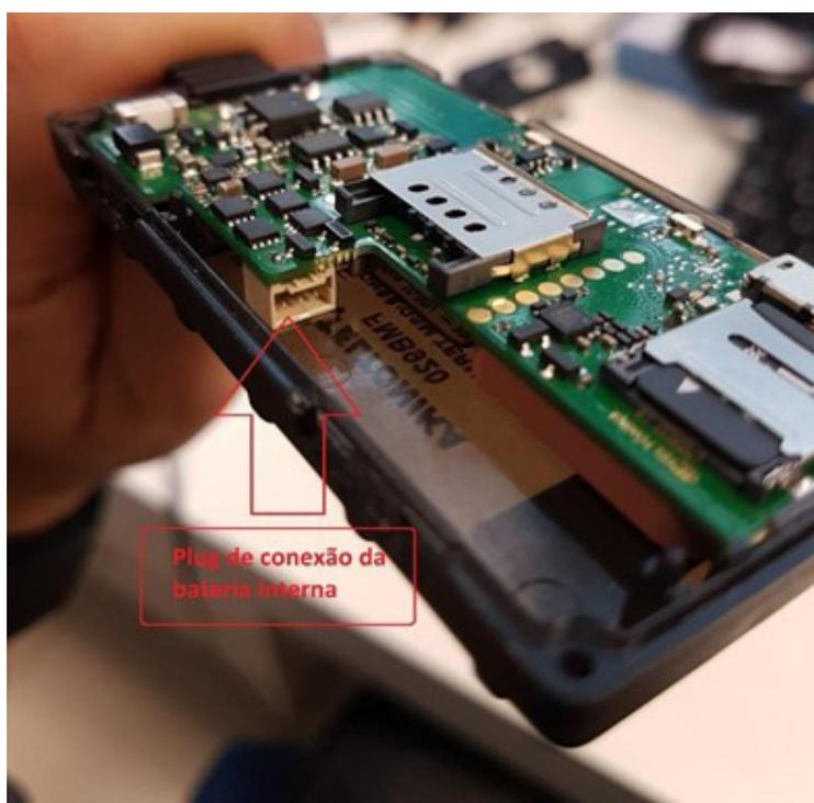
A imagem abaixo demonstra o equipamento com a bateria conectada e o posicionamento do cabo da bateria lateralmente encaixado para permitir que o equipamento possa ser fechado corretamente.
